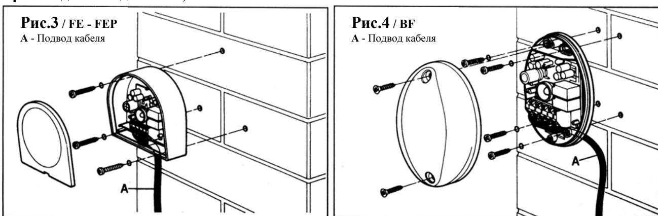
**FE - FEP - BF:** подайте на барьер постоянный/переменный ток 12 - 24 В; если барьер правильно соединен и выровнен, красный светодиод на приемнике будет выключен.
