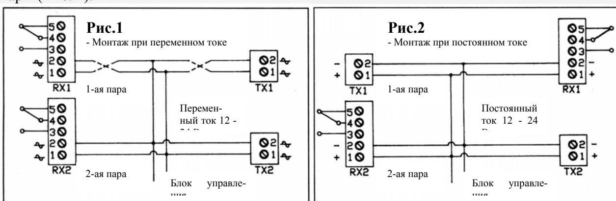
Синхронная работа может также использоваться на одной паре для получения более точного функционирования и снижения потребления мощности.
