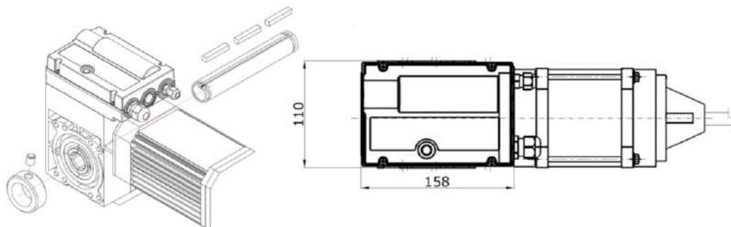
При установке редукторных двигателей с валом диаметром 31,75 мм слева вкладыш можно фиксировать только крепежным кольцом, поскольку при использовании винта имеется риск повреждения вала.
