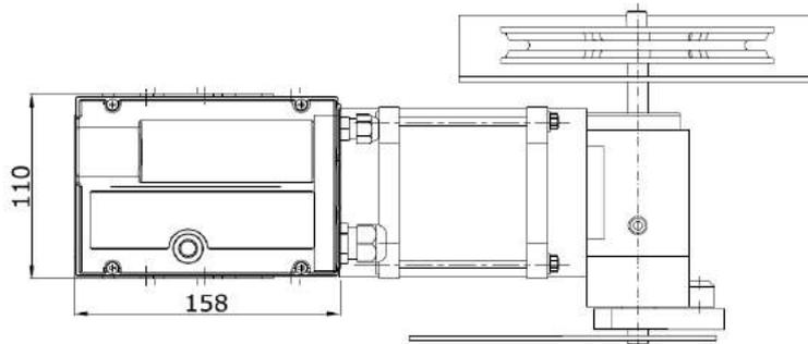
При установке редукторных двигателей с валом диаметром 31,75 мм слева вкладыш можно фиксировать только крепежным кольцом, поскольку при использовании винта имеется риск повреждения вала.
