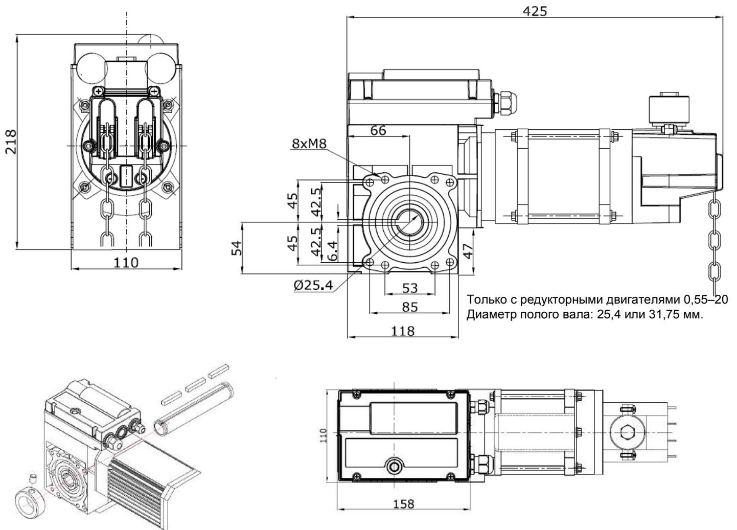
При установке редукторных двигателей с валом диаметром 31,75 мм слева вкладыш можно фиксировать только крепежным кольцом, поскольку при использовании винта имеется риск повреждения вала.
